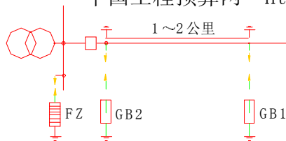
图 5.2.2 35 千伏变电所的进线保护接线
