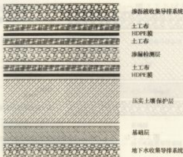
图 3.2.2-2 双层防渗结构示意图
