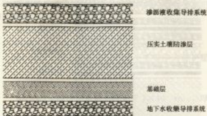
图 3.2.2-1c 压实土壤单层防渗结构示意图
