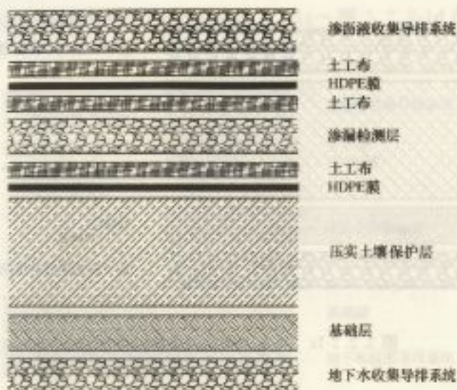
图 3.2.2-2 双层防渗结构示意图
