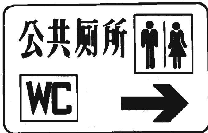
注：制作尺寸比例：长度  $L$ 、宽度  $0.618L$ 、圆周半径  $\frac{1}{20}L$ 。
